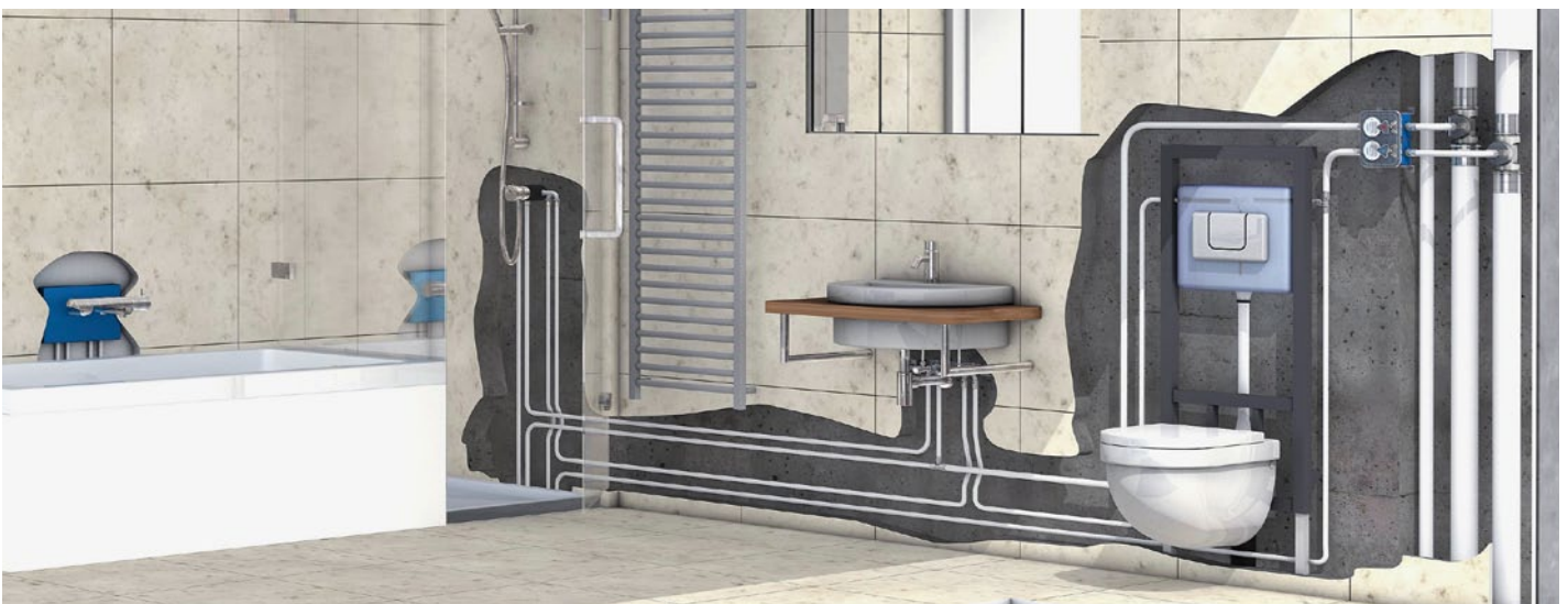
In einer Unterputzmontage, beispielsweise in der Vorwand, kann nahezu jede Richtungsänderung ohne zusätzliche Fittings ausgeführt werden.
